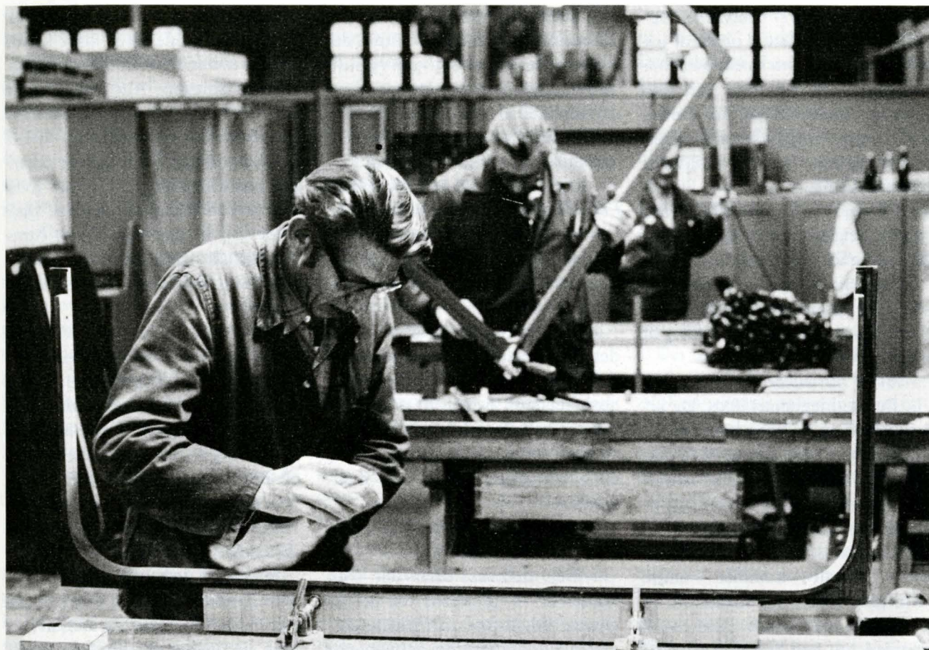
De gamle vinduesrammer kan bruges igen efter en oppudsning.
